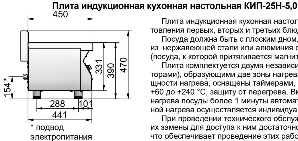
Плита индукционная кухонная настольная **КИП-25Н-5,0** предназначена для приготовления первых, вторых и третьих блюд в специальной наплитной посуде.
